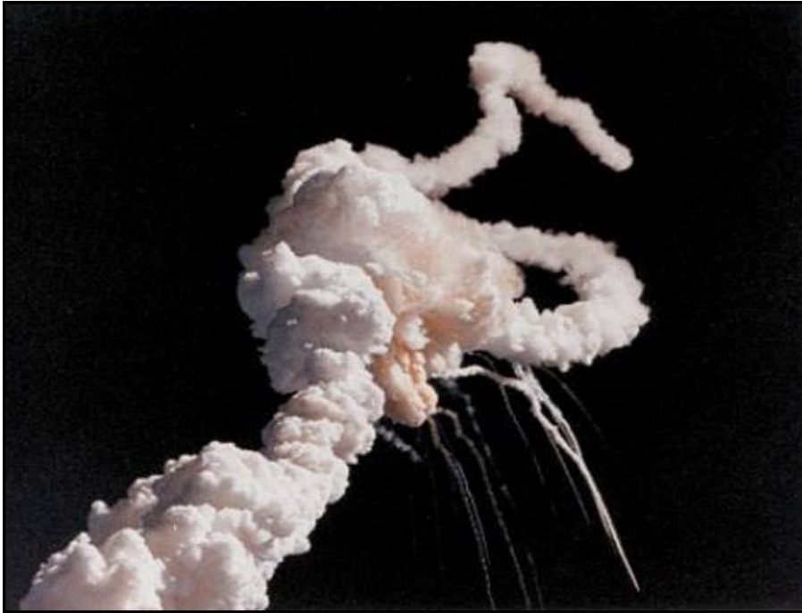
그림 3.70 챌린저 우주왕복선 폭발사고(Space Shuttle Challenger disaster)는 1986년 1월 28일에 미국의 챌린저 우주왕복선의 발사 73초 후 고체 연료 추진기의 이상으로 인한 폭발로 7명의 대원이 희생된 사고이다. 챌린저호는 열 번째 임무인 STS-51-L을 위해 발사된 직후였다. 이 사고로 탑승하고 있던 승무원 7명 전원이 사망하는 인명피해와 4865억원의 금전적 손실을 입었다. 외부연료탱크의 폭발 직후, 보조추진로켓은 분리되어 불규칙적으로 날아가고 있다. 연료탱크의 폭발로 발생된 연기 내에서는 챌린저호 본체가 압력에 의해 분해되었다.
