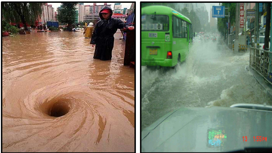
사진 : (좌)침수된 시가지의 무서운 하수구 소용돌이(1998년 의정부시 : 하수구의 상당부분이 비어 있음을 보이고 있음)와 (우)2005년 9월 13일 오후 1시55분 경의 서울 신촌 로타리 부근의 침수상황(20분간 약23mm의 호우로 침수된 도시홍수의 전형이다)
